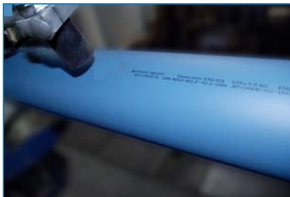
Фот. 22. Труба dBlue - в процессе нанесения маркировки
